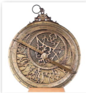
Астролябия — прибор, с помощью которого моряки измеряли в открытом море высоту звезд над горизонтом
